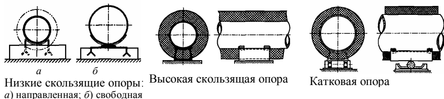
Рис. 1.30. Варианты высоких и низких опор
