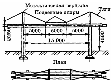
Рис. 1.25. Надземный теплопровод подвесной конструкции на мачтах
