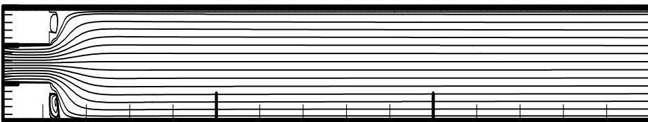
Рис.6. Линии тока при течении проводящей ( Ha = 10.0 ) жидкости при Re = 130 .
