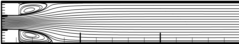
Рис.5. Линии тока при течении проводящей ( Ha = 3.1 ) жидкости при Re = 130 .
