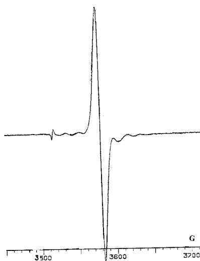
Рис.1.Спектр ЭПР каталитической системы \text{TiCl}_4 / олигопиперилен + \text{Al}(\text{i-C}_4\text{H}_9)_3 в растворе толуола с добавлением пиридина. \text{Ti}/\text{Al}=1 . \text{TiCl}_4/\text{олигопиперилен}=1/10 . T=293\text{K}
