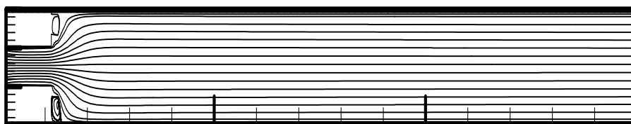
Рис.6. Контурные линии тока при течении проводящей нелинейно-вязкой жидкости при Re = 200 .
